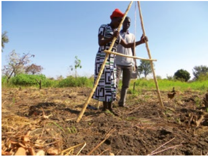
የመሬቱን ተዳፋታማነት A-ፍሬም በመጠቀም መወሰን ፎቶግራፍ በ ቶማስ ኮል
