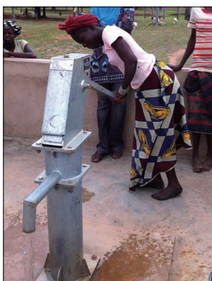
Recolhendo água de um poço com uma bomba manual
